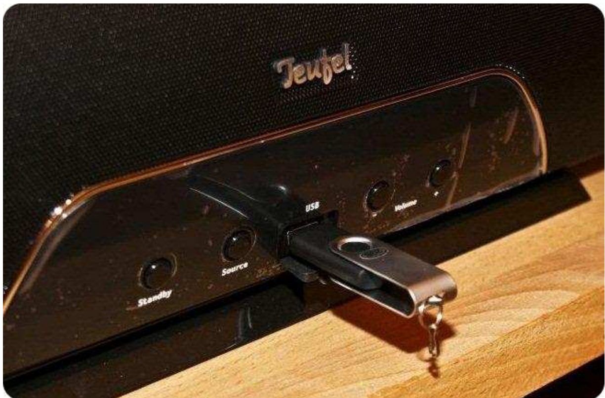
Hinter der Gummiblende versteckt sich die USB -Buchse
