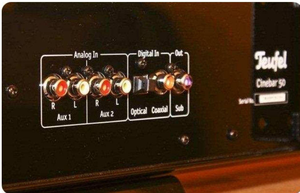
Das rückseitige Anschlussfeld der Cinebar 50
