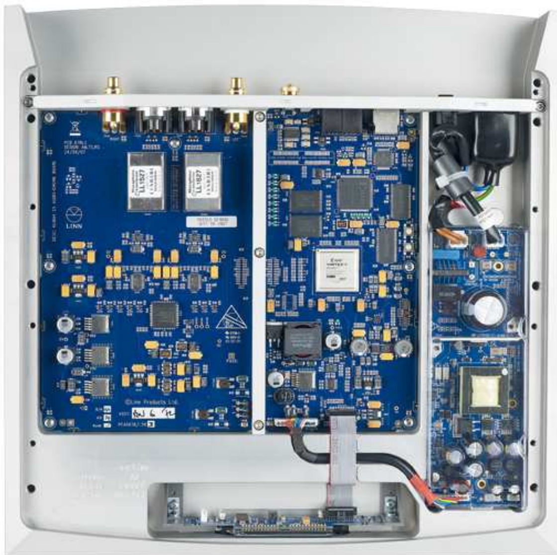
Aus einem einzigen Block Aluminium wurde das Gehäuse gefräst. Foto: Linn
