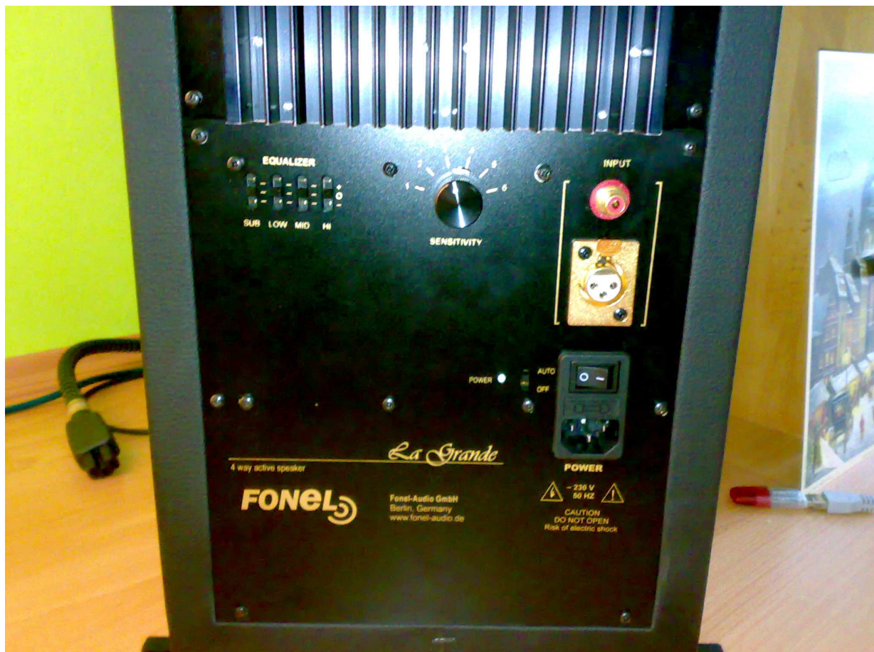
Das Anschlussterminal ist bereit zur Kontaktaufnahme, egal ob Cinch oder XLR.
